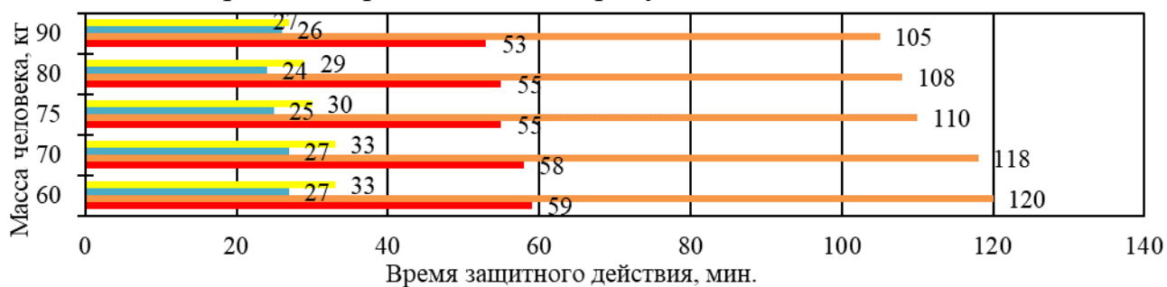
Рисунок 11– Зависимости времени защитного действия при использовании части дыхательного воздуха, не участвующего в легочном газообмене (ИВНЛГ) от дыхательной нагрузки в сравнении с временем защитного действия без ИВНЛГ: ■ – в режиме отдыха без ИВНЛГ; ■ – в режиме отдыха с ИВНЛГ; ■ – при средней нагрузке без ИВНЛГ; ■ – при средней нагрузке с ИВНЛГ
