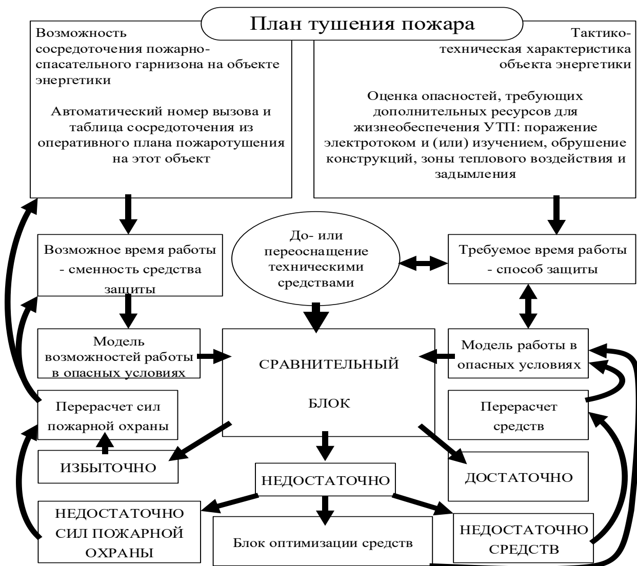
Рисунок 20 – Метод локализации пожаров объектов энергетики
