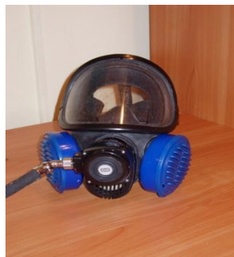
Рисунок 10 – Схема устройства для использования части дыхательного воздуха, не участвующего в легочном газообмене
